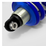
Réglage détente et système de Détente Rapide (DetRa®)
